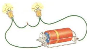
(図1) 豆電球の直列つなぎと回路図
