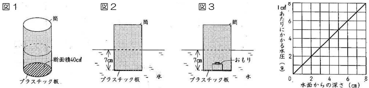
(図1)のような断面積が  $40\text{ cm}^2$  の筒と、底面積が  $40\text{ cm}^2$  のプラスチック板があります。プラスチック板を(図2)のように筒の下にぴったりと重ね、 $7\text{ cm}$  だけ水中にすずめたところ、プラスチック板は筒についたままになりました。(グラフ)は、水中の物体が水から受ける力について考えたときの、物体の水面からの深さと物体に  $1\text{ cm}^2$  あたりにかかる力(水圧)との関係を表したものです。これについて、次の問いに答えなさい。ただし、筒やプラスチック板の厚さや重さは考えないものとします。
