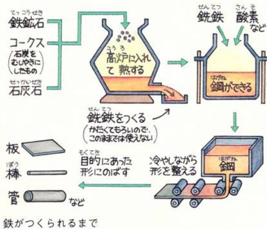
鉄鉱石にふくまれている酸化鉄に、石炭を蒸し焼きにしてつくった**(2…炭素の固まり)**と石灰石を加えて**(3…?鉄)**をつくり、それに酸素を加えて鋼をつくります。製鉄業ともいい、金属工業の中心です。鉄鋼生産量の世界1位は**(4…外国名)**ですが、品質では日本が世界のトップレベルです。また、製鉄所は原料の輸出入に便利な**臨海部(海沿いの地域)**につくられます。
