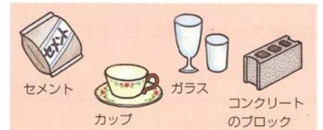
が窯業です。ニューセラミックスともいわれる(27…カタカナ)などの焼き物は、固くて熱に強くさびないため、ナイフ・電子部品・自動車部品・人工骨などに広く用いられています。
